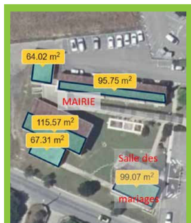
Zone d'étude de la mairie, avec les surfaces potentielles pour l'installation de panneaux photovoltaïques.
